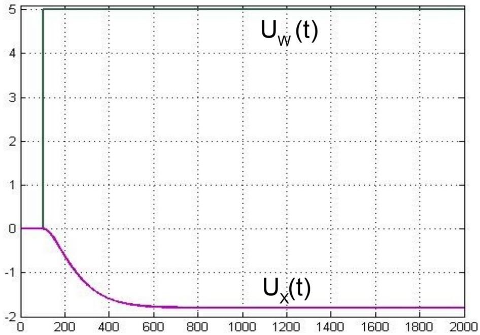
Abbildung 2.4.2b: Führungsverhalten des Regelkreises zu 2.3.2
