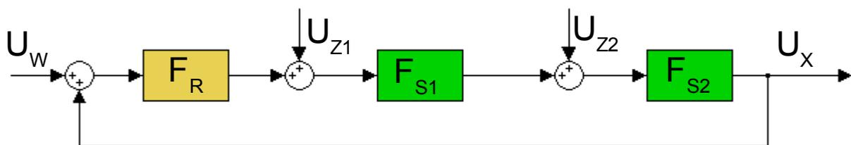
Abbildung 2.4.2: Signalflussplan PT<sub>2</sub>-Strecke und P-Regler
