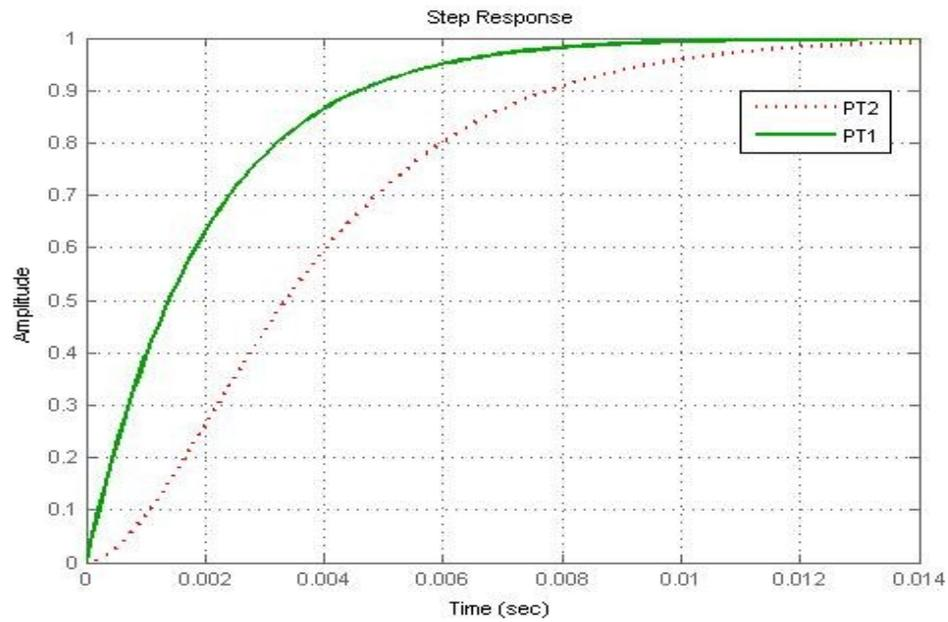
Abbildung 2.2.2a: Sprungantwort einer PT<sub>1</sub>- bzw PT<sub>2</sub>-Strecke
