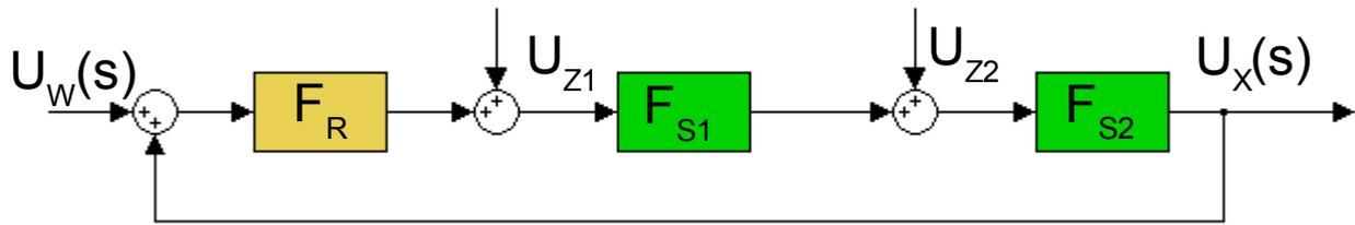
Abbildung 2.3.2a: Signalfussplan PT<sub>2</sub>-Strecke und P-Regler
