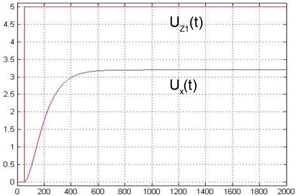
Abbildung 2.4.2c: Sprungantwort des Störverhaltens 1 zu 2.4.1.1
