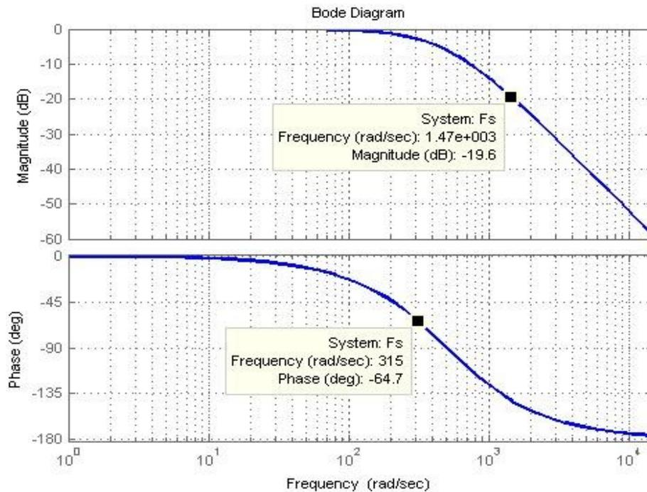
Abbildung 2.1.3a: Bodediagramm der Gesamtstrecke
