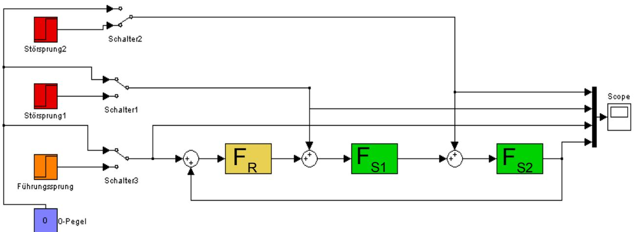
Abbildung 2.4.2a: Simulinkmodell des Regelkreises
