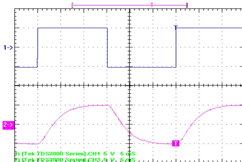
Abbildung 2.2.3a: Gemessene Sprungantwort einer PT<sub>2</sub>-Strecke
