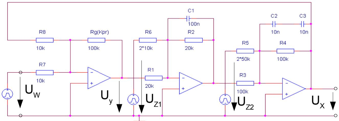
Abbildung 2.3.1: Regelkreis aus  $PT_2$ -Strecke und P-Regler
