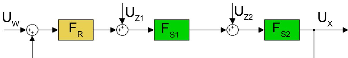
Abbildung 2.4: Signalflussplan  $PT_2$ -Strecke und P-Regler
