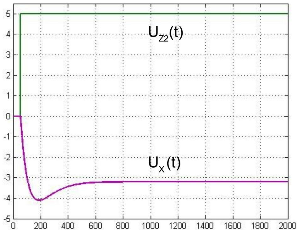
Abbildung 2.4.2d: Sprungantwort des Störverhaltens 2 zu 2.4.1.2
